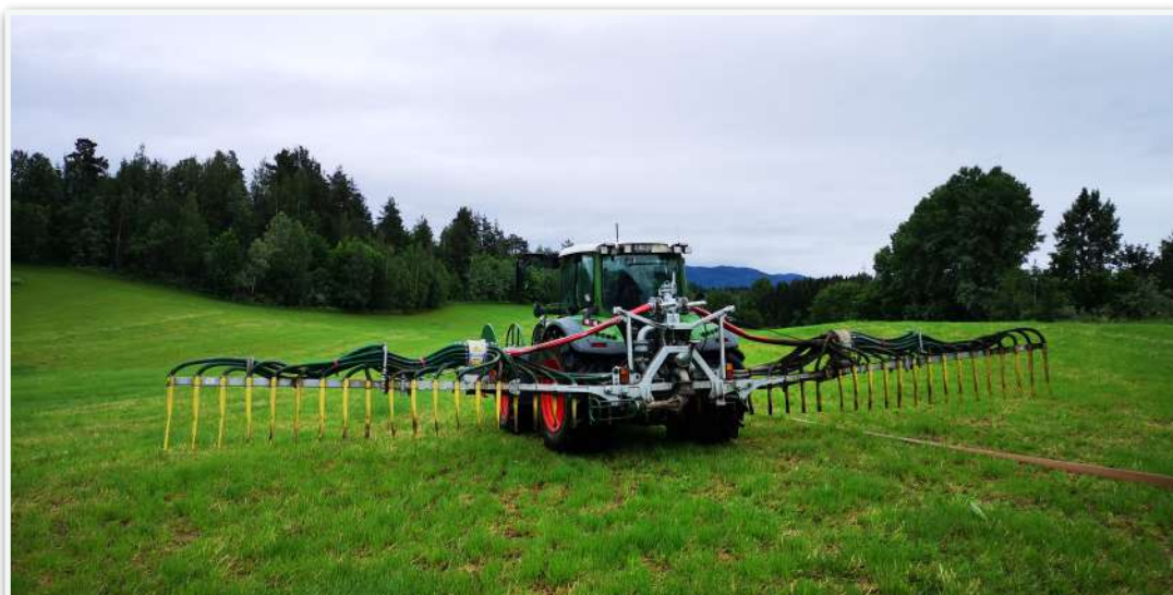
Bøhn ute på jordet og sprer møkk og bioest med slepeslange. Foto: privat
